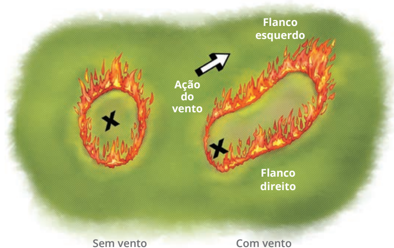
Esquema de propagação do fogo em função do vento
