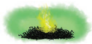
Liberação de chama produzida pelo contato entre combustível não queimado e combustível carbonizado
