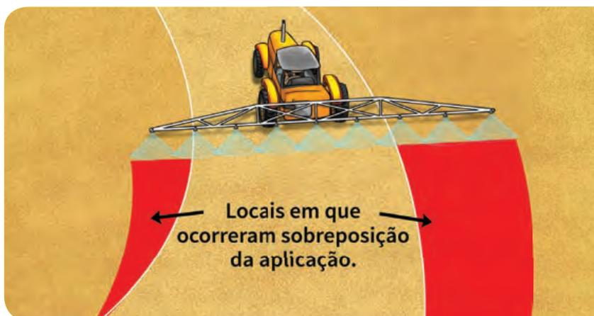
O controle automático de seções permite o desligamento independente das seções, reduzindo a largura aplicada de acordo com a necessidade.
