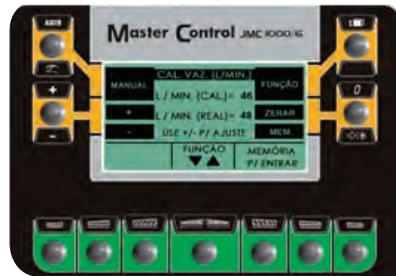
O valor da constante também é corrigido automaticamente quando é feita a calibração da vazão em litros por minuto.
