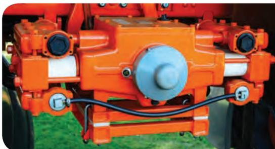
A bomba de pistão, em pulverizadores com controladores eletrônicos, possui uma câmara de compensação, que tem a função de manter o fluxo constante em função da alternância dos pistões, evitando a intermitência da pulverização.
