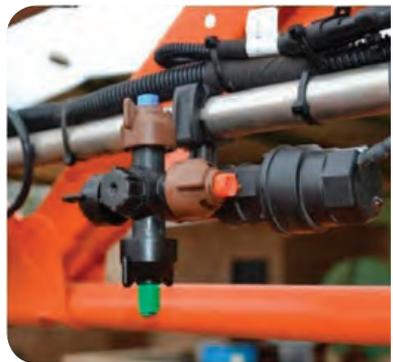
Quando o pulverizador se depara com uma faixa de trabalho de largura inferior à largura da barra, o sistema fará o desligamento das seções necessárias, visando evitar a sobreposição da aplicação de agrotóxicos.
