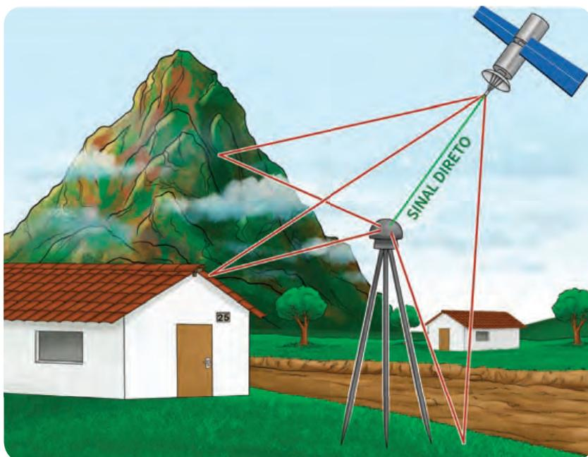
Parte dos erros dos sistemas GNSS é corrigida por diversos métodos ou serviços, que fazem as correções durante o processamento dos dados, melhorando o posicionamento do receptor, atingindo uma acurácia de até 2,5 cm. As correções dependem do nível de tecnologia embarcada no pulverizador.
