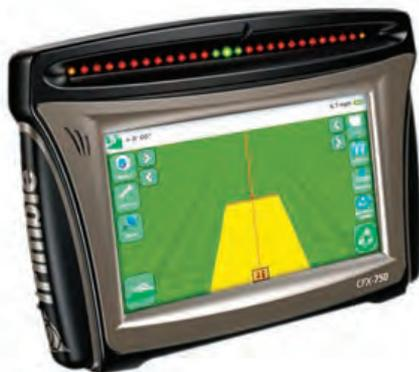
Ao final da linha, realize a manobra da máquina. A próxima linha paralela irá aparecer no monitor e será a nova referência para o operador. Alguns equipamentos diferenciam as linhas paralelas criadas em relação a original AB. Podem ser identificadas como direita e esquerda ou por algarismos positivos e negativos.
