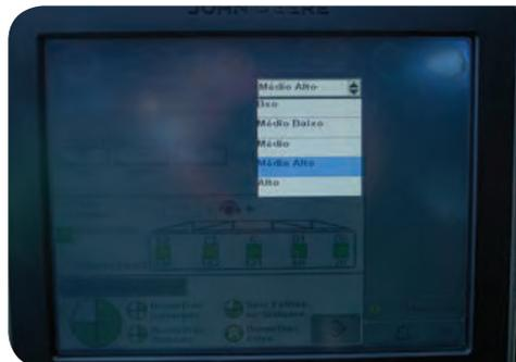
A forma de regulagem do sensor de altura da barra e suas possíveis configurações, variam de acordo com a marca e modelo do pulverizador. Para fazer essa regulagem, portanto, consulte o manual do operador do pulverizador específico.
