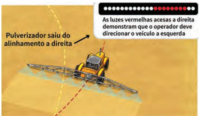
Outros modelos complementam os LEDs, com uma pista de visualização no monitor, mostrando detalhes da largura de trabalho e da linha de referência.
