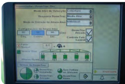
O modo “topo da planta” (Canopy) é utilizado em culturas densas, quando os sensores de altura da barra podem não detectar o solo. Este modo faz com que um sensor de altura da barra de pulverização reaja ao primeiro obstáculo que detecte verticalmente em relação ao solo.
