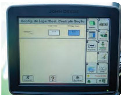
Os valores de início e fim da pulverização já vêm preestabelecidos de fábrica e podem ser alterados em função da velocidade de trabalho e tipo de sinal utilizado.
