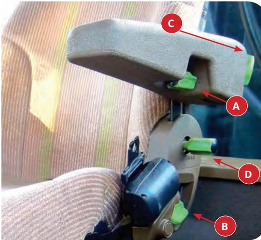
A - Alavanca de ajuste do ângulo do apoio do braço
