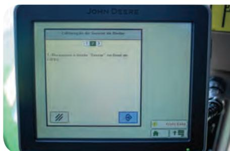
Alguns modelos de pulverizadores possuem controladores que permitem correlacionar dois sistemas de aquisição da velocidade, com o objetivo de maior precisão desse dado. Nesse caso, a velocidade considerada é a média da velocidade obtida na roda com a aquela obtida a partir do sinal GNSS.
