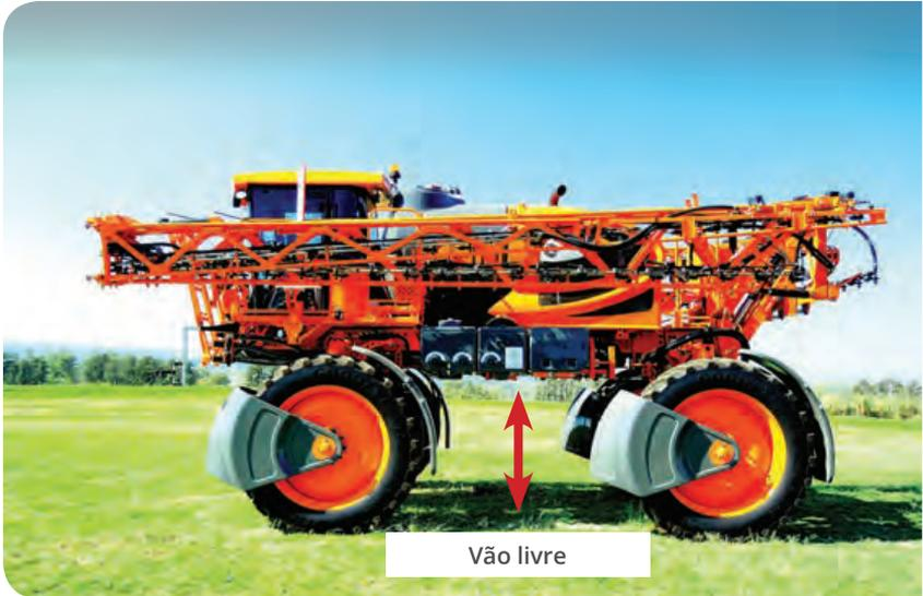
Na maioria dos pulverizadores autopropelidos, essa medida é fixa, ou seja, é uma característica construtiva da máquina. Já em outros, essa medida é ajustável e pode ser alterada conforme a necessidade de utilização do equipamento.
