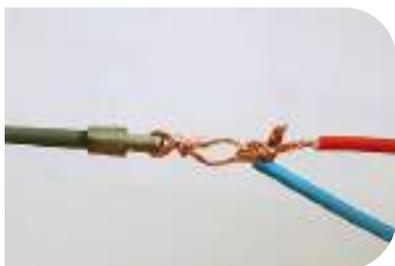
Enrole a ponta do condutor para prendê-lo na sonda e abra um espaço entre as "pernas" do condutor para inserir a ponta do próximo condutor que passará pelo eletrodo
