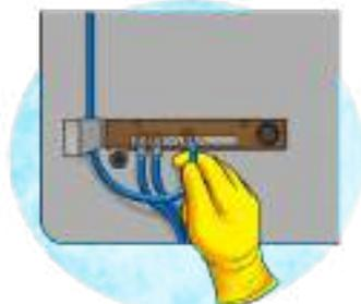
Uso de terminal no barramento do quadro de distribuição de circuitos
