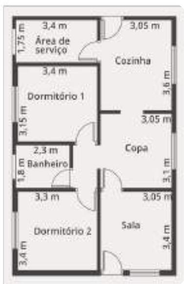
Planta baixa do domicílio com medidas e definição dos cômodos
