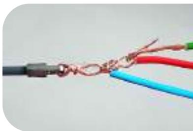
Faça o mesmo com o próximo condutor que passará pelo eletrodo, fixando todos na sonda de forma "escalonada", evitando formar um "caroço" na ponta da sonda
