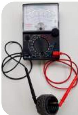
e) Faça a leitura do valor da resistência elétrica na escala indicada a seguir, sendo este o valor da resistência elétrica em ohms vezes 1 (1X)
