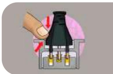
O plugue cobre a cavidade e impede contatos
