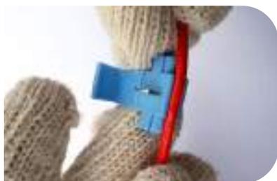
Levante a tampa do conector e leve o fio para um dos canais existentes
