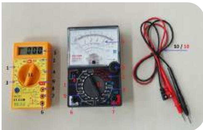
O multímetro tem pelo menos quatro funções e suas escalas, um seletor de funções e escalas, um mostrador e encaixes dos cabos para ligá-lo aos pontos de medição.
