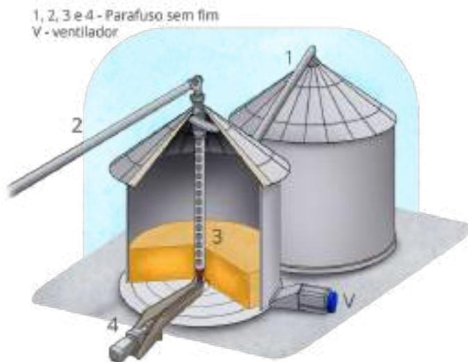
Vista em corte de um secador e do silo armazenador
