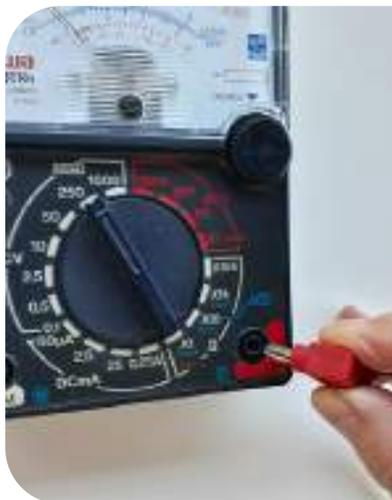
c) Posicione o seletor de funções no quadrante de corrente elétrica DCmA, na escala de maior valor de corrente, 0,25 A (250 mA)
