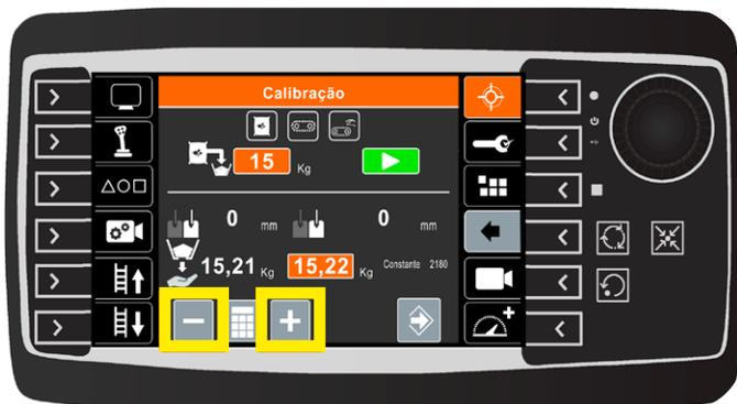
Caso o valor coletado seja diferente do valor informado no monitor, o equipamento fará a correção da constante automaticamente.
