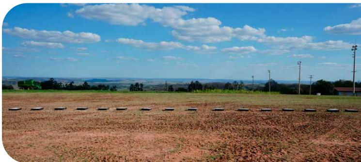
A quantidade de bandejas e a distância entre elas é definida em função da largura do perfil, da granulometria e do peso específico do produto a ser distribuído. Para obter essa informação, consulte o manual do operador do distribuidor.
