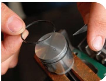
**b) Coloque uma extremidade do anel inferior na canaleta superior, girando-o, até que se encaixe nela por completo; e**
