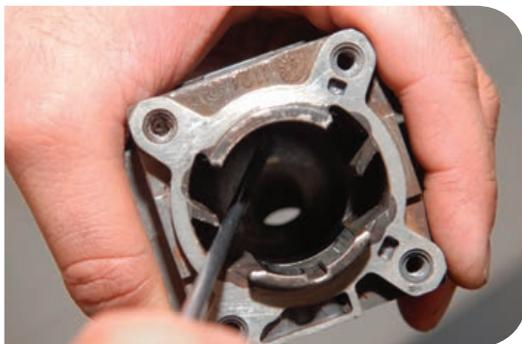
6.8.2 Descarbone a saída para o escapamento usando uma chave de fenda
