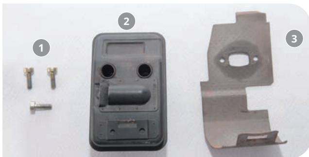
Parafusos de fixação (1); Silencioso / Escapamento (2); e Junta (3)
