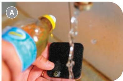
Lavando-o com água e detergente neutro, quando o filtro for de espuma
