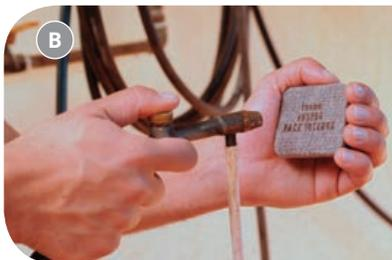
Retirando sujidades com ar comprimido, quando o filtro for de feltro
