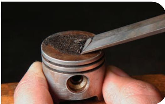
6.9.2 Remova os anéis, descarbonizando sua parte interna
