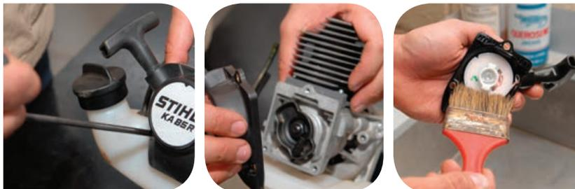
**6.6. Remova o módulo de ignição, retirando o excesso de sujeira com um pano ou estopa seca**
