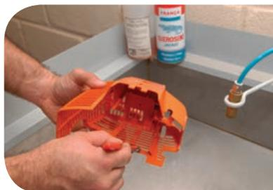
6.1.2 Solte o cabo do acelerador e os fios do módulo de ignição
