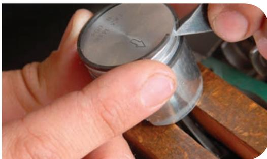
a) Coloque uma extremidade do anel superior na cabeça do pistão, girando-o, até que se solte;
