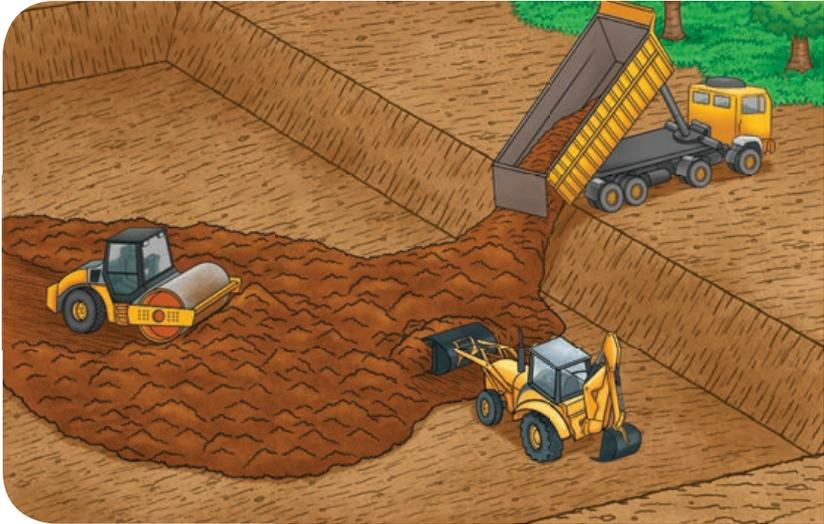
Preenchimento de núcleo de talude com material de alta qualidade para aumentar a estabilidade e reduzir a infiltração. Compactação de material de núcleo com rolo compactador
