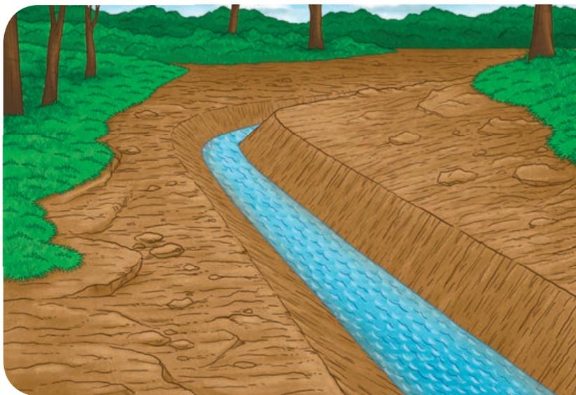
Canal escavado em formato trapezoidal, sem revestimento
