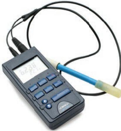
Medidor de pH eletrométrico
