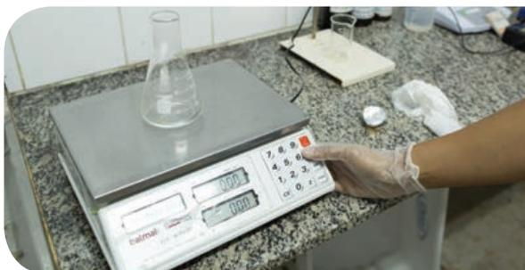
e) Pese 60 g de camarão em um Erlenmeyer com a balança devidamente tarada. Anote o peso para ser utilizado na fórmula/cálculo do teor de dióxido de enxofre ( $\text{SO}_2$ ) da amostra
