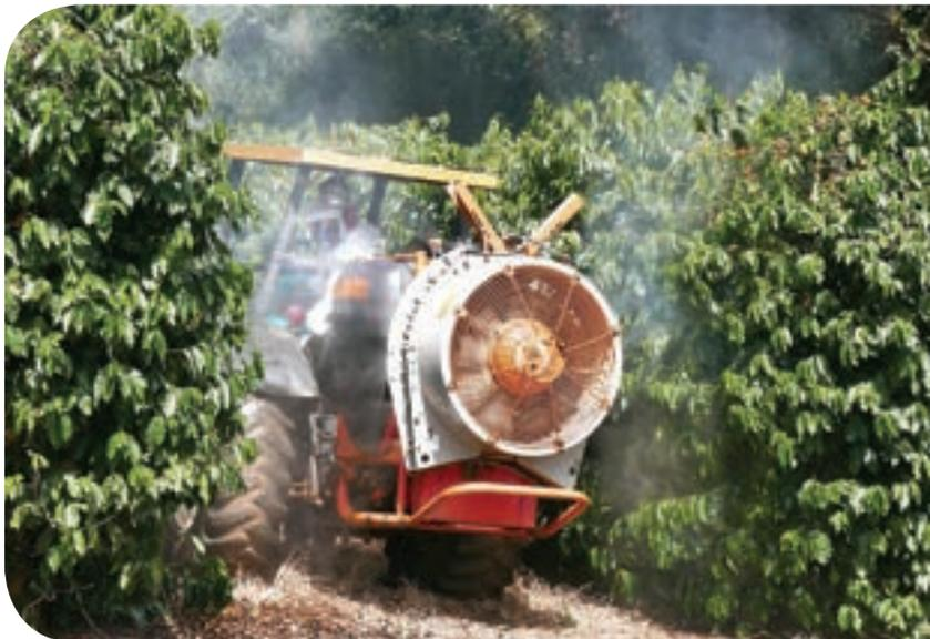
Controle químico mecanizado com pulverizador de 400 ou 2000 litros
