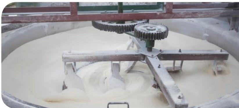
A massa deve ser movimentada, do início ao final do processo, com o auxílio de palhetas mecânicas ou manuais, até que se transforme em farinha torrada.
