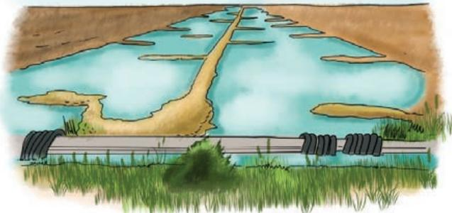
Nesse sistema, a água é aplicada individualmente em cada faixa por estruturas hidráulicas ou sifões. Quando a água é retirada da faixa, o volume acumulado sobre a superfície do solo avança para a parte mais baixa do terreno, infiltrando-se e permitindo aplicação da lâmina de irrigação.
