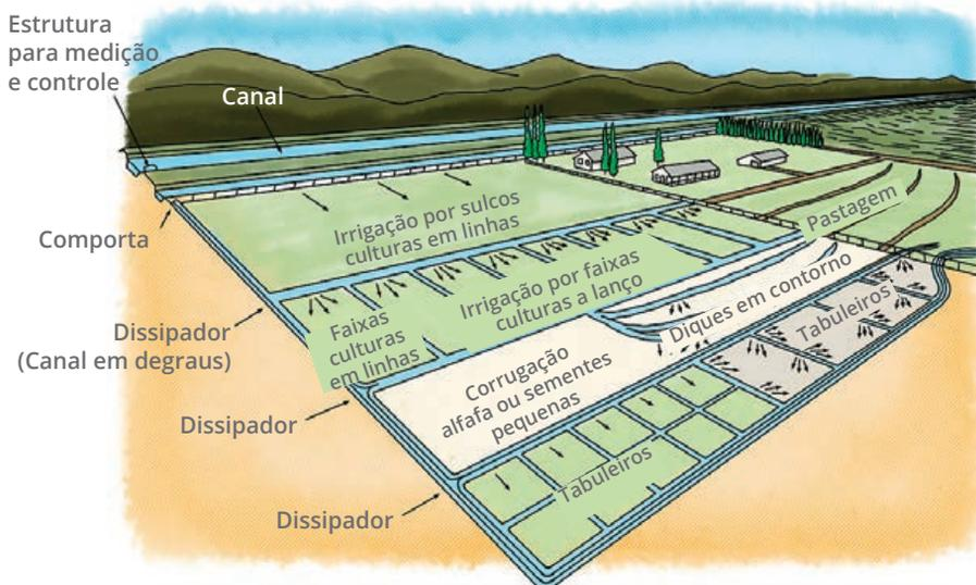
Os sistemas de irrigação por superfície recebem, também, o nome de sistemas de irrigação por gravidade, uma vez que a água é aplicada diretamente sobre a superfície do solo e, pelo efeito da gravidade, se movimenta e nele se infiltra. Esse tipo de sistema apresenta a maior porcentagem de área irrigada no mundo em relação aos sistemas pressurizados.
