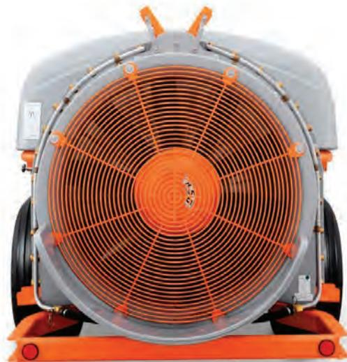
A energia para a movimentação dos ventiladores pode ser fornecida pela TDP ou por um motor próprio do pulverizador. Quando a energia for fornecida pela TDP a rotação é ampliada para o ventilador por meio de polias e correias ou ainda por engrenagens.
