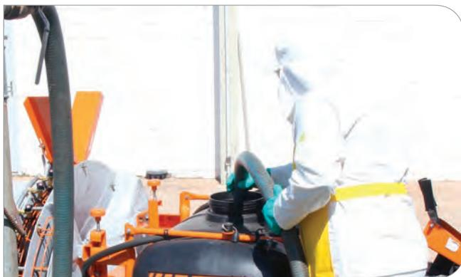
**b) Ligue a bomba do circuito de pulverização na rotação indicada para agitar a calda**
