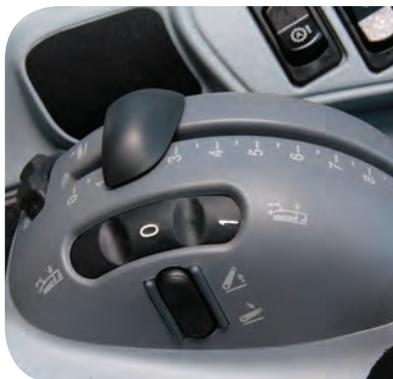
Alguns tratores possuem interruptor externo para acionamento do sistema hidráulico.
