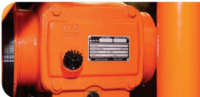
A bomba de pistão, a qual equipa os pulverizadores, possui uma câmara de compensação, cujo propósito é manter o fluxo constante em função da alteração dos pistões, evitando a intermitência da pulverização.
