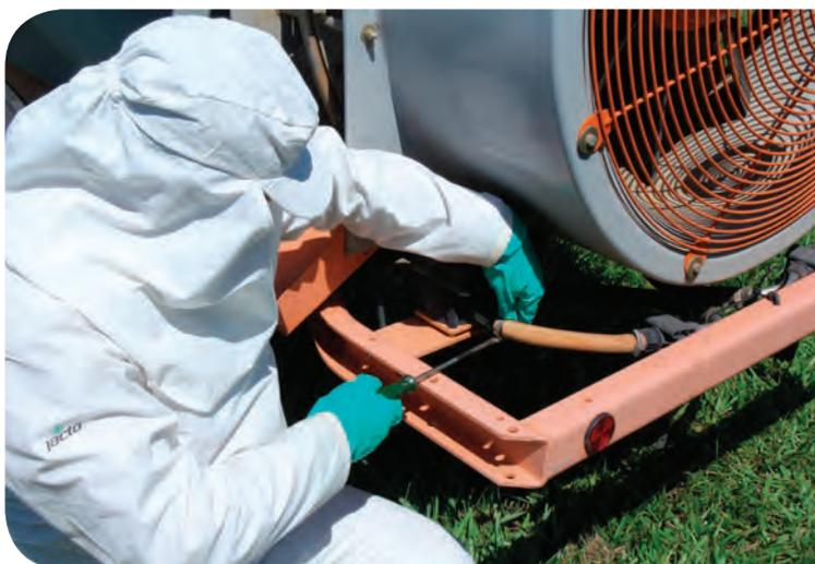
**o) Verifique se há vazamentos nos bicos, válvulas e filtros**
