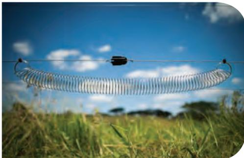
**4.1. Instale um isolador de canto (castanha) no fio energizado entre duas estacas - a do desviador de raios e a próxima**
