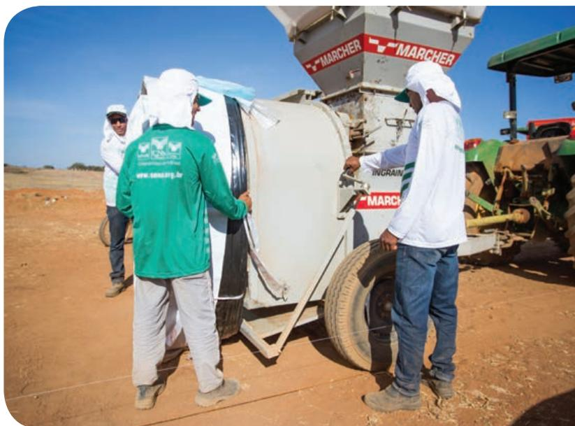
Ao montar o saco na máquina de enchimento, observe se os marcadores de estiramento estão num lado onde podem ser vistos e medidos quando o saco está sendo enchido.
