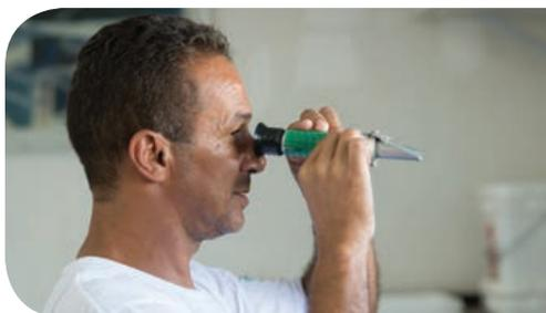
**7.2.3. Observe o valor marcado em azul (mais escuro) na fita de medição interna (ele indica a salinidade da água)**
