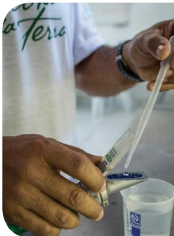
**7.2.2. Aponte o refratômetro para a luz e olhe dentro do aparelho a fita de medição da salinidade**
