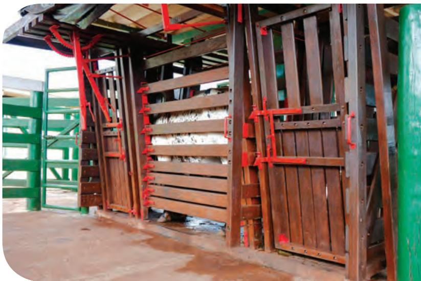
O brete é uma instalação útil para as propriedades dedicadas à bovinocultura. É construído junto ao curral e permite a contenção individual de animais. Ainda é considerado um equipamento de custo relativamente alto e pode ser construído em estrutura metálica, embora os mais comuns sejam de madeira. Existem bretes de diversas marcas e formas, diferenciando-se pela qualidade do material e quantidade de estruturas de guilhotinas e portinholas.
