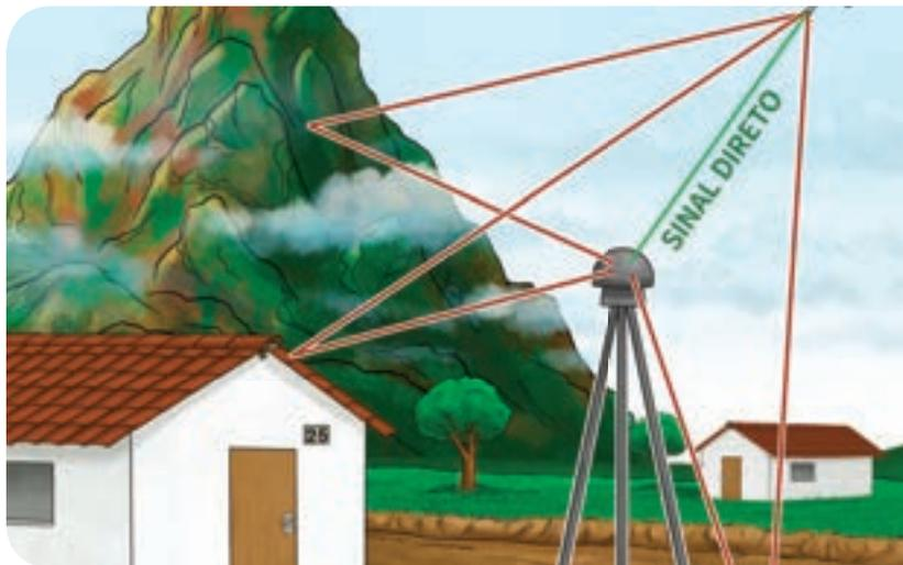
Parte dos erros dos sistemas GNSS é corrigida por diversos métodos ou serviços, que o fazem durante o processamento dos dados, melhorando a precisão do posicionamento do receptor e atingindo uma precisão de até 2,5 cm. Essas correções dependem do nível de tecnologia embarcada no conjunto trator-distribuidor.
