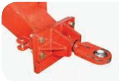
Na barra de tração, é parafusado o cabeçote que forma a “boca de lobo” no trator.
