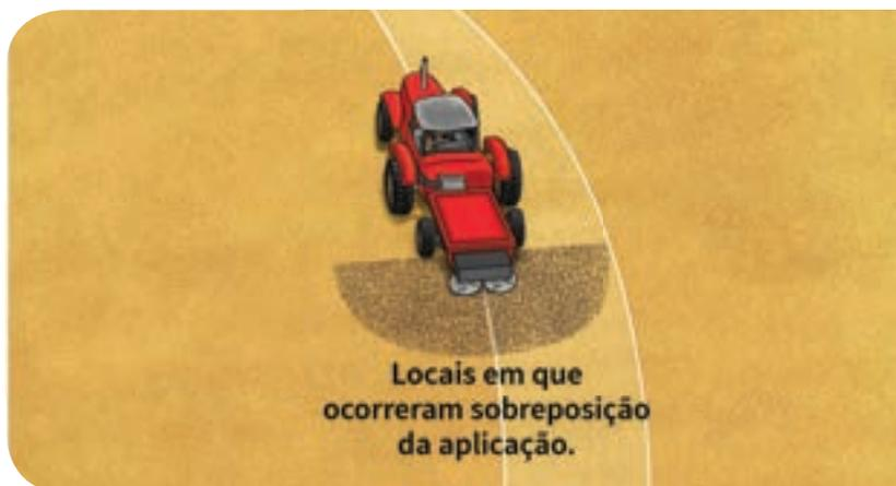
O controle automático de seções permite o desligamento independente das seções, reduzindo a largura aplicada de acordo com a necessidade.
