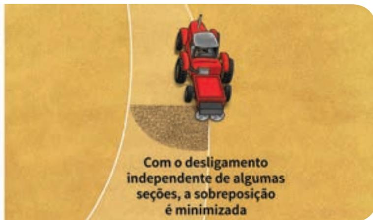
Se o distribuidor não possui controle automático de seções, ocorrerá a sobreposição da aplicação.
