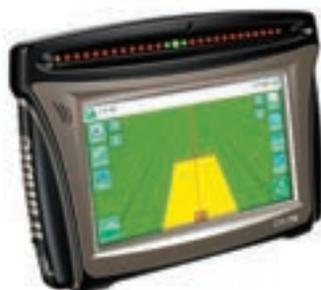
Ao final da linha, realize a manobra da máquina. A próxima linha paralela irá aparecer no monitor e será a nova referência para o operador. Alguns equipamentos diferenciam as linhas paralelas criadas em relação à original AB, podendo ser identificadas como direita e esquerda ou por algarismos positivos e negativos.
