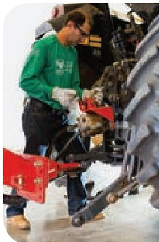
Este tipo de distribuidor utiliza apenas a rotação da tomada de potência para acionamento da bomba. Os cuidados e a sequência correta do acoplamento da bomba na tomada de potência do trator são fornecidos no manual do operador do distribuidor.
