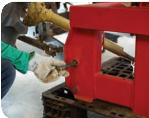
Alguns tratores possuem esta alavanca ou este interruptor externo para acionamento do sistema hidráulico.
