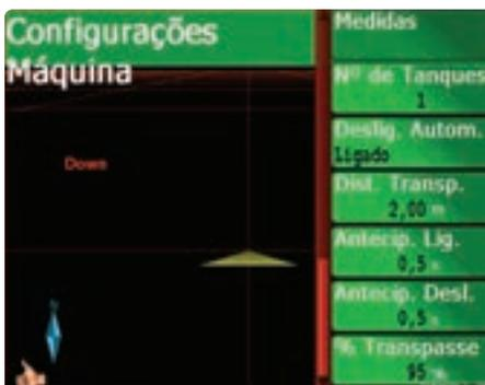
Os valores de início e fim da aplicação já vêm preestabelecidos de fábrica e podem ser alterados em função da velocidade de operação e do tipo de sinal utilizado.
