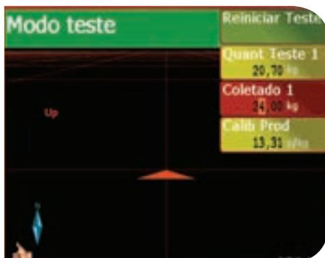
Em distribuidores que são equipados com controlador eletrônico, a velocidade da esteira é acionada por motor hidráulico. Assim, a medida que é alterada é a velocidade de operação, e ocorre também a alteração da vazão pela variação da velocidade da esteira, mantendo constante a taxa de aplicação.
