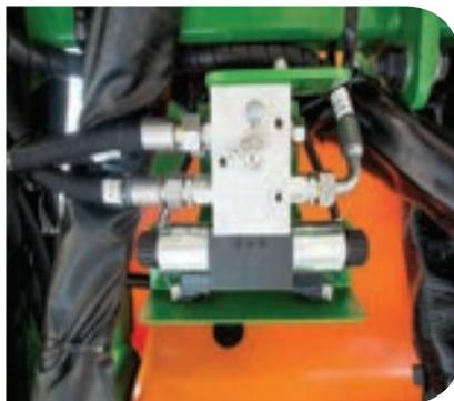
O controle da seção é feito por válvulas que controlam a abertura e o fechamento das comportas ou o ligamento e o desligamento da esteira do distribuidor.
