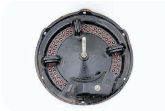
A regulação deste sistema é feita mediante a troca do disco de sementes ou da relação de transmissão e varia de acordo com o modelo da máquina.
