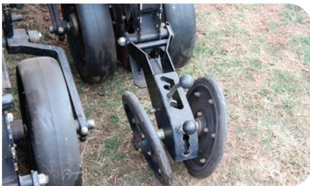
As rodas compactadoras em “V” possuem duas alavancas com molas localizadas no final da linha de semeadura. A primeira ajusta a abertura e o fechamento do ângulo entre as rodas compactadoras, o que determina a quantidade de solo depositado sobre o sulco de semeadura, e a segunda ajusta a pressão da roda no fechamento lateral do sulco.
