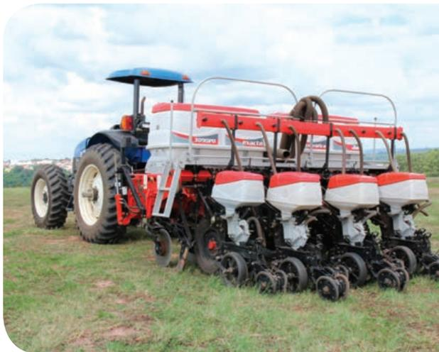
Atualmente, os reservatórios são fabricados em polietileno (plástico), o que possibilita que a temperatura interna seja mais adequada ao armazenamento das sementes.
