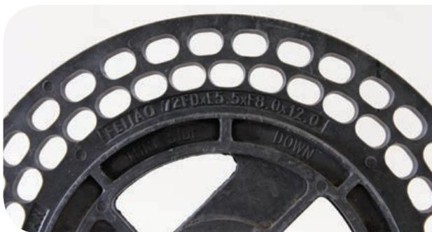
Os discos utilizados nas semeadoras mecânicas ficam posicionados horizontalmente e a semente, obrigatoriamente, deverá entrar no furo para ser dosada, enquanto que nas semeadoras pneumáticas, o disco fica na posição vertical e a semente fica aderida ao furo, posicionada externamente ao disco.
