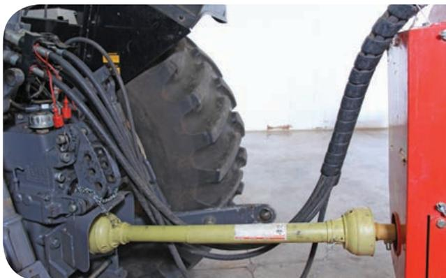
Este tipo de semeadora-adubadora utiliza apenas a rotação da tomada de potência para acionamento da bomba.
