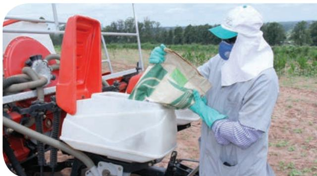
Para facilitar a lubrificação e a saída das sementes do mecanismo dosador, deve-se usar grafite na proporção adequada. Geralmente utiliza-se 100 gramas de grafite para cada 100kg de sementes.
