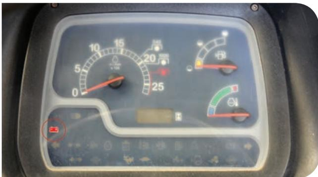
**1.6 Verifique o indicador de saturação do filtro de ar do motor. Se necessário, substitua o elemento filtrante**
