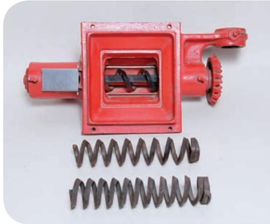
Os dosadores do tipo helicoidal são os mais comuns e a dosagem do adubo é determinada pela combinação de engrenagens na caixa de transmissão e pelo tipo de helicoides que está montado no mecanismo dosador; e
