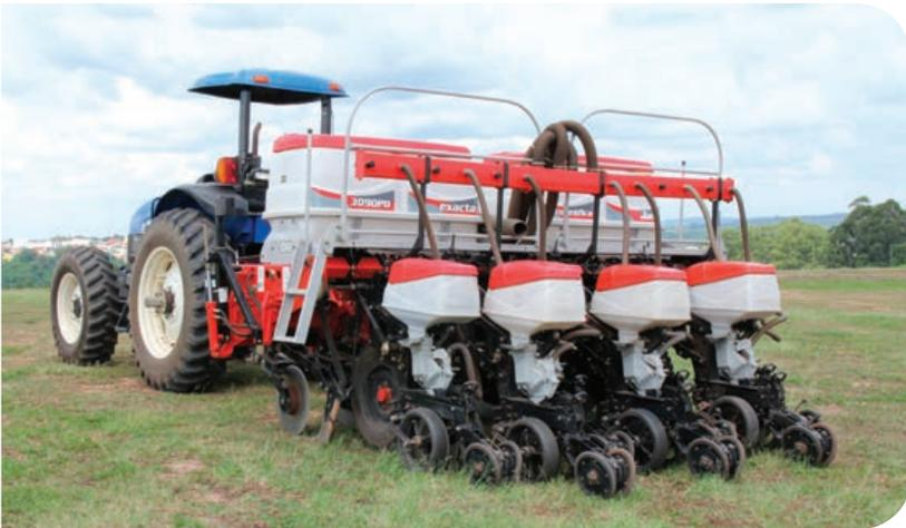
As semeadoras-adubadoras podem ser classificadas quanto a forma de distribuição das sementes, acionamento, tamanho da semente e mecanismo dosador.
