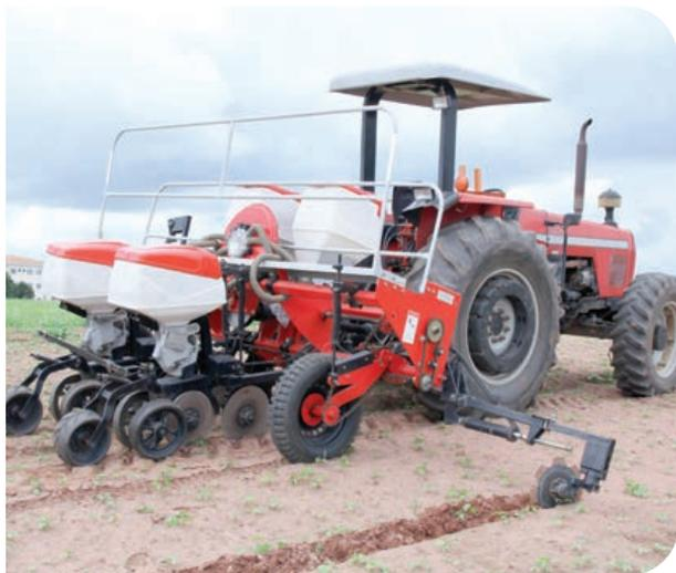
Devido ao fato de o marcador de linhas possuir braços telescópicos ajustáveis, pode-se regular o seu comprimento em função do espaçamento entre linhas e da bitola dianteira do trator.
