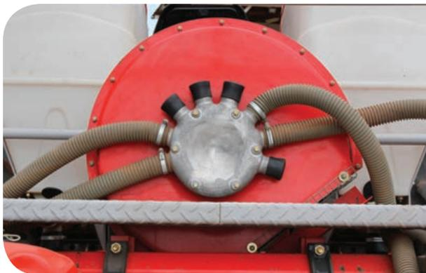
No sistema de pressão, um disco vertical gira, aprisionando a semente de um reservatório localizado em sua base. A pressão do ar mantém as sementes presas em orifícios e, em determinado ponto é feito o corte da pressão, liberando as sementes para o solo.
