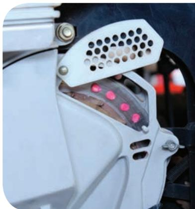
O disco perfurado da semeadora mecânica é selecionado de acordo com a semente adquirida. Normalmente, neste tipo de máquina, existem, para cada cultura, discos com furos grandes, médios e pequenos, para o ajuste adequado à semente.
