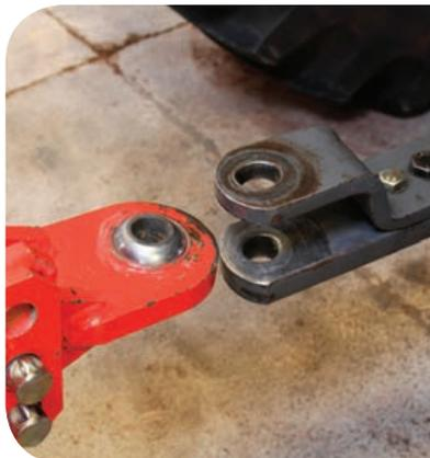
Na barra de tração, é parafusado o cabeçote que forma a “boca de lobo” no trator.
