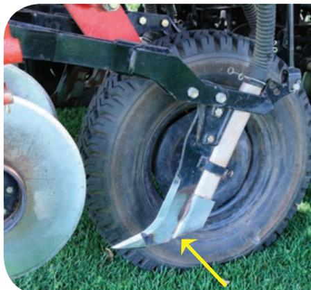
A operação com haste sulcadora exigirá maior demanda de energia do trator para realizar o deslocamento da semeadora-adubadora.
