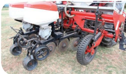
Sua função principal é garantir a sustentação do cabeçalho, dos reservatórios para fertilizantes e sementes, do sistema de transmissão, dos sistemas de dosagem e distribuição de fertilizantes e sementes e dos demais componentes da semeadora.
