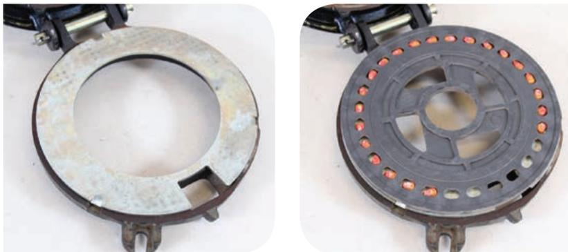
Após a montagem do disco no dosador, é necessário verificar se o mesmo não está com seu movimento de giro aprisionado, pois isto poderá danificar ou quebrar sua parte central, devido ao esforço realizado pelo movimento da roda de acionamento do dosador.
