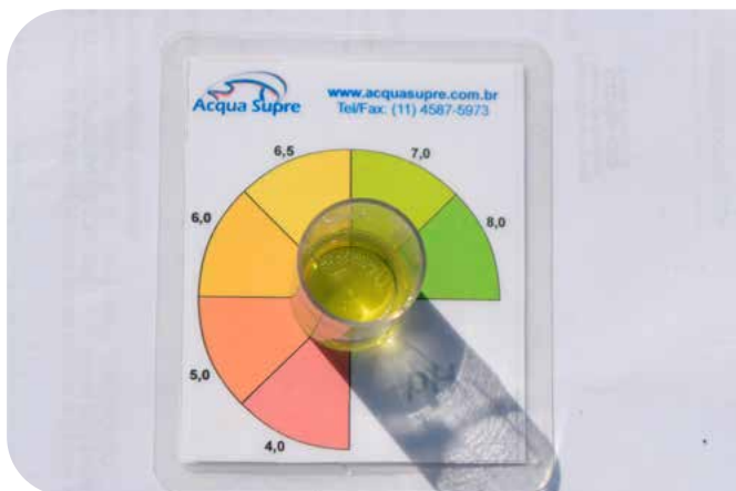
Amostra homogeneizada comparando com a escala de cor
