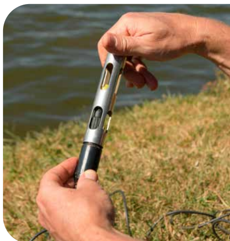
Sequência de fotos mostrando a substituição da membrana e a solução da sonda de oxigênio
