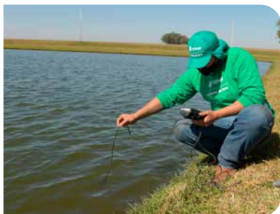
Medição de oxigênio e movimentação da sonda por cerca de 30 cm a cada segundo
