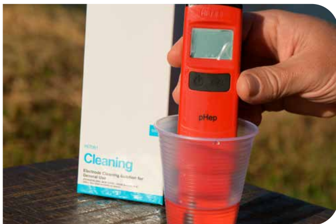
Processo de lavagem da sonda com água destilada
