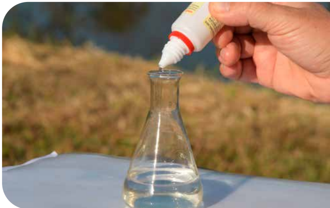
Amostra de água recebendo o reagente 1 da análise de dureza total
