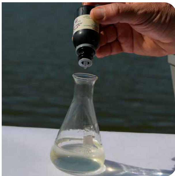
Amostra de água recebendo o reagente 1 da análise de gás carbônico
