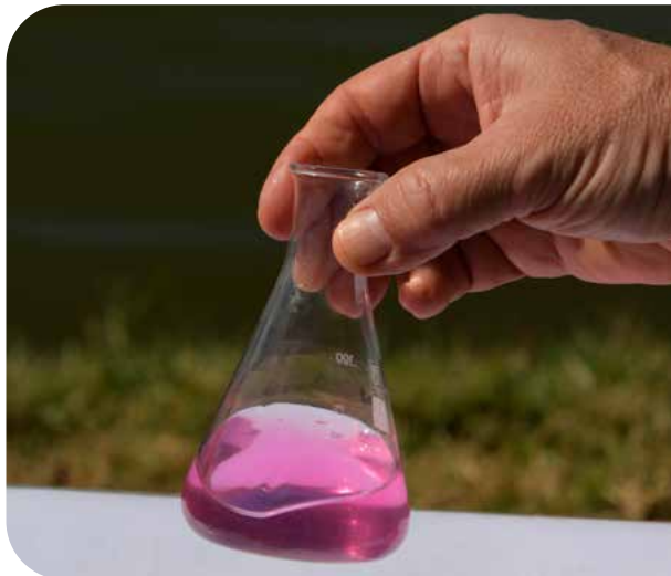
Amostra de água no ponto da virada de cor após receber o reagente 2 da análise de gás carbônico
