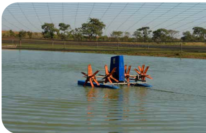
Aerador de pás parado
