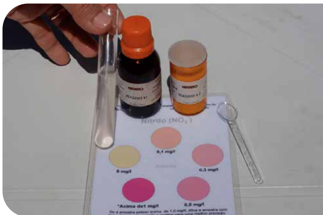
Comparação da amostra de água com a tabela após receber os reagentes 1 e 2 da análise de nitrito
