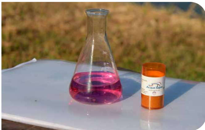
Amostra após receber o reagente 2 durante a análise de dureza total
