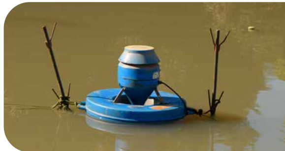
Aerador tipo chafariz fixado com estaca dentro do viveiro
