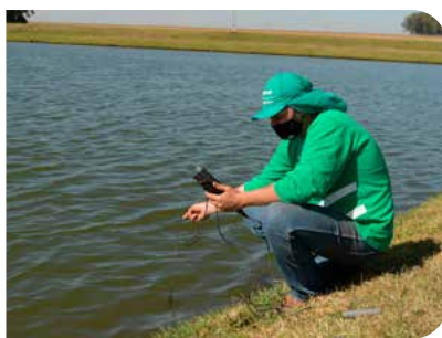
Medição de oxigênio e movimentação da sonda por cerca de 30 cm a cada segundo
