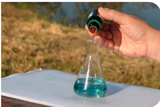
Amostra com o reagente 1 indicador para análise de alcalinidade total
