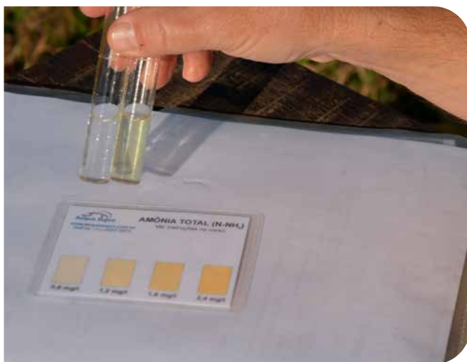
Comparação na escala de cor da medição de amônia total
