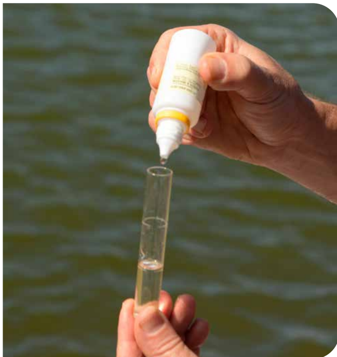
Amostra de água recebendo o reagente 2 da análise de amônia total
