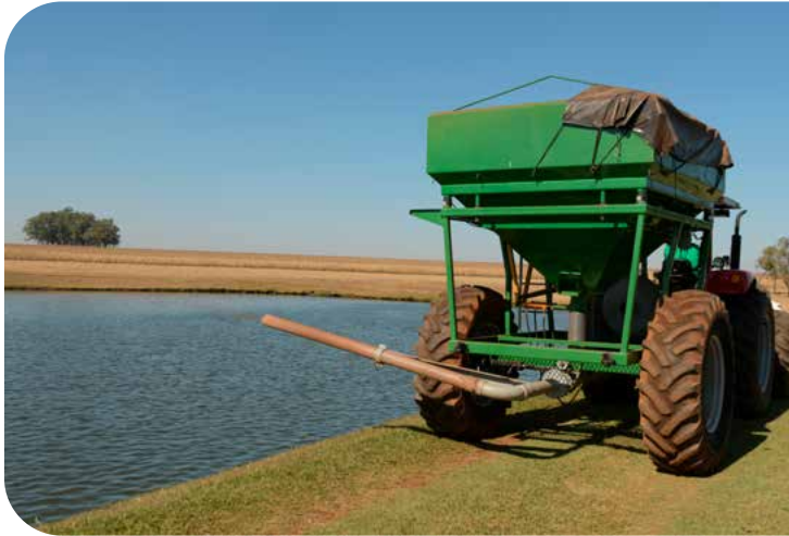
Alimentador montado em cima de uma carreta de trator
