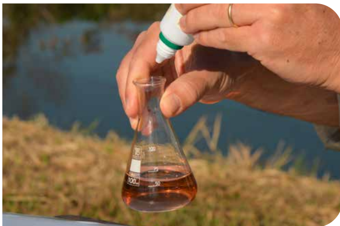
Amostra no ponto da virada de cor durante a titulação com o reagente 2 da análise de alcalinidade total
