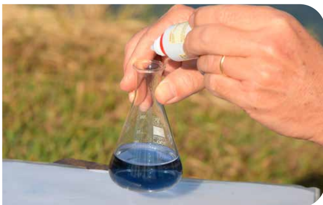
Amostra no ponto da virada de cor durante a titulação com o reagente 3 da análise de dureza total
