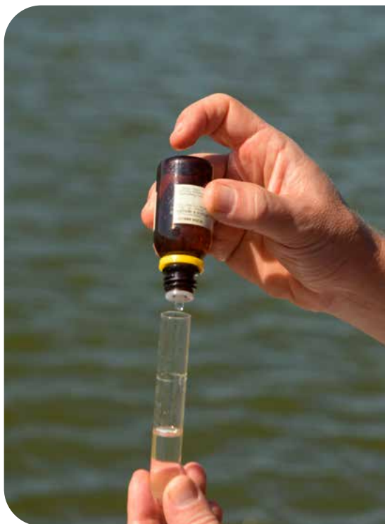
Amostra de água recebendo o reagente 1 da análise de amônia total
