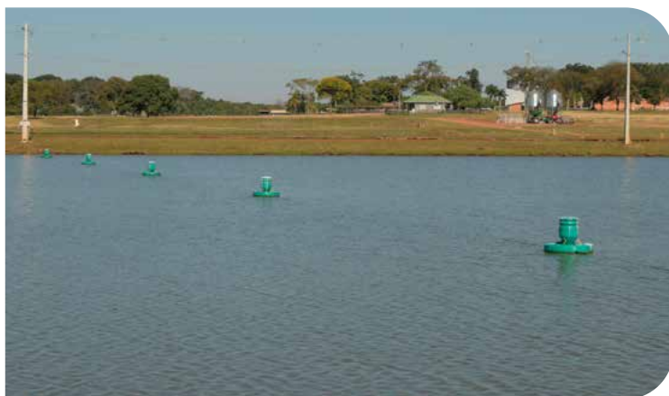
Aerador tipo chafariz fixado na margem com corda
