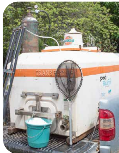
Caixa de transporte com isolamento térmico
