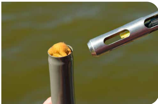
Detalhe da capa de proteção com esponja úmida para armazenamento da sonda
