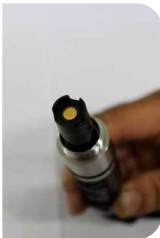
Sonda galvânica com membrana intacta e limpa
